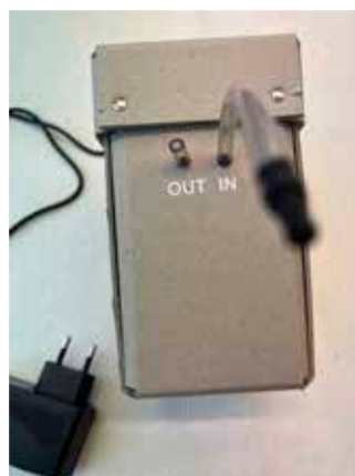
AIR- IN tilsluttes vakuumrammen AIR- OUT må ikke blokeres
